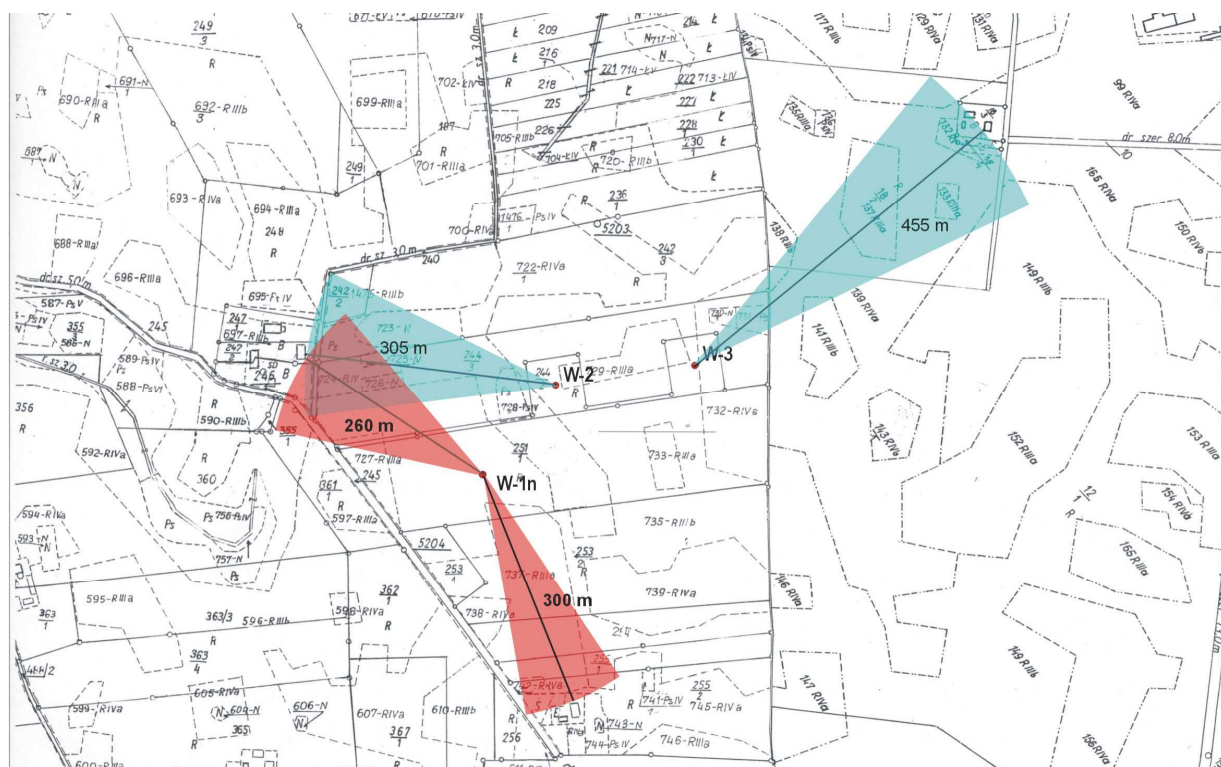
Ryc. 18. Proponowana lokalizacja elektrowni wiatrowej W-1 o mocy 2MW. Na mapie podano minimalne odległości od najbliższych budynków mieszkalnych jaki powinny zostać zachowane przy wyznaczaniu miejsca usytuowania masztu
